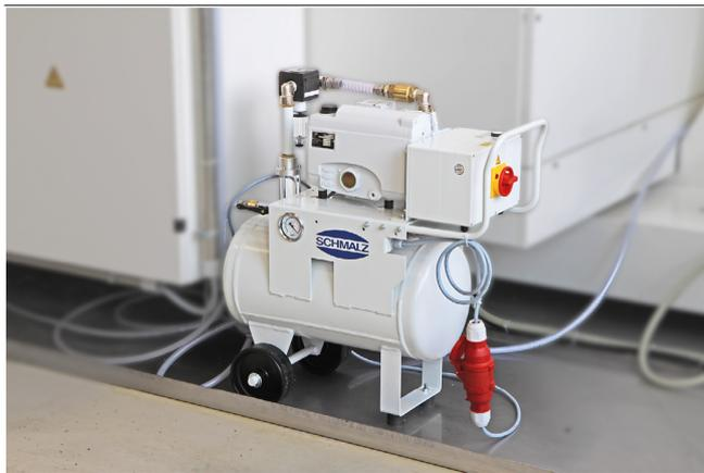
Unité de vide VAGG pour la génération du vide pour l'usinage en milieu humide
